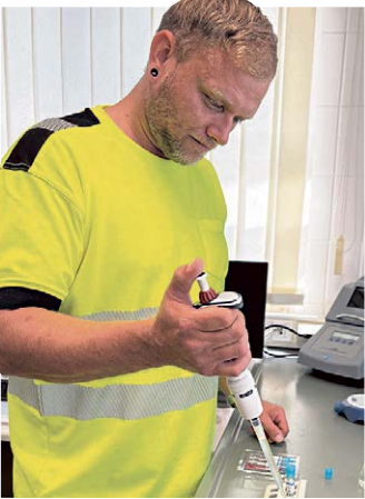
Nitrit, Nitrat, Ammonium, Phosphat: Andy Neumann nimmt im Labor die Ablaufwerte der Kläranlage Heiligengrabe in den Blick.
