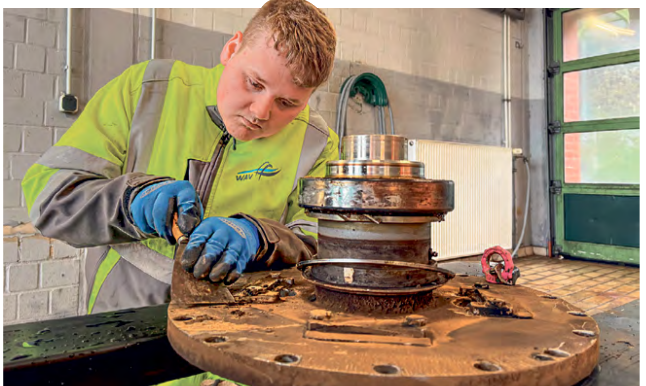
Während seiner Ausbildung erhält Ole tiefe Einblicke in die Technik hinter der Abwasserentsorgung – so wie hier, an der Trommel für die Klärschlamm-Zentrifuge.
